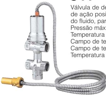
Válvula de descarga térmica, de ação positiva, com reposição automática do fluido, para caldeiras a combustível sólido. Pressão máx.: 6 bar. Temperatura máx.: 110°C. Campo de temperatura: 5÷110°C. Campo de temperatura ambiente: 1÷50°C. Temperatura de descarga: 100°C (0/-5°C).
